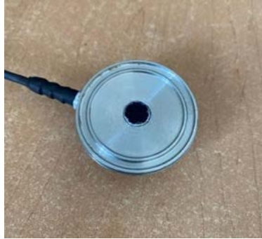
Fig. 5. Micrófono electret adaptado a campana de estetoscopio.
