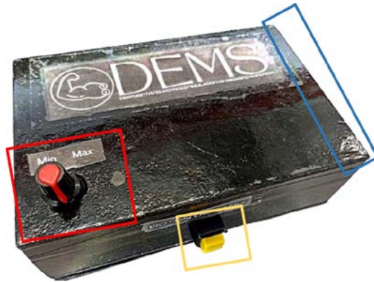
Fig. 10. DEMS. Control de intensidad (cuadro rojo). Paro de emergencia (cuadro amarillo). Recuadro azul: puertos de conexión.
