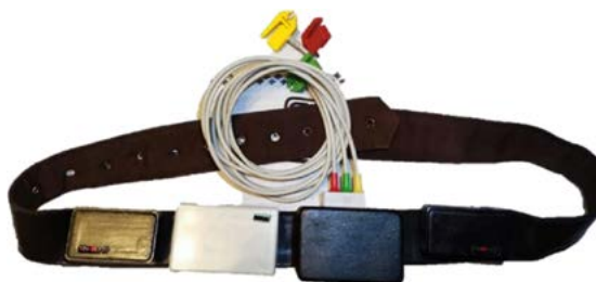
Fig. 4. “Sleep belt”, prototipo de dispositivo para la integración del análisis biomecánico y la estadificación del sueño.
