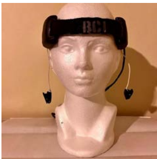
Fig. 6. Prototipo de banda para adquisición de señales EEG.
