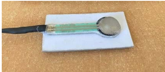
Fig. 12. Sensor de presión con domo de resina epóxica.
