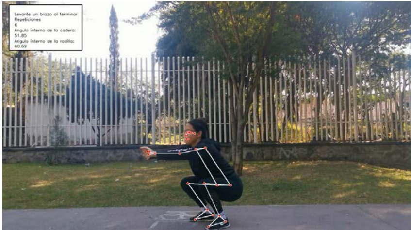
Fig. 3. Cuadro de un video siendo procesado. Se observan los puntos de las articulaciones detectadas en rojo con un esqueleto en blanco. En la esquina superior izquierda se encuentra un cuadro mostrando las repeticiones, ángulo interno de la cadera y ángulo interno de la rodilla actual.
