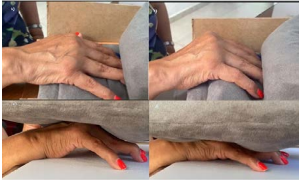
Fig. 4. Visualización del sistema neumático en distintas etapas: a) Estado inicial de los actuadores encargado de la flexión. Mano en posición neutra; b) Actuadores inferiores (de flexión) llenos de aire. La mano logra un realizar el movimiento de agarre de fuerza; c) Actuadores de flexión en reposo. Mano en posición neutra; d) Actuadores de flexión inyectados de aire. Mano extendida debido a la presión de los actuadores.
