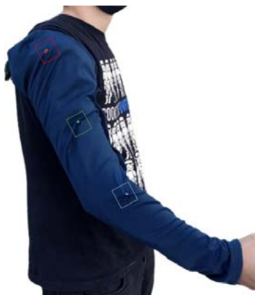
Fig. 12. Manga con electrodos. Indicador, rojo en la sección del hombro, el verde en la sección del brazo y el azul en el antebrazo.
